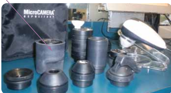
Le diverse ottiche usate in abbinamento alla microcamera
